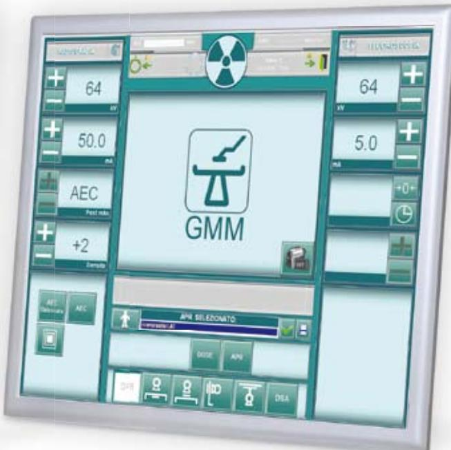
Il dispositivo di rilevazione del prodotto dose area è completamente integrato nel generatore e i dati sono visualizzati direttamente sulla consolle di comando. Il dispositivo DAP consente la gestione di due tubi RX e può essere completato con una stampante per etichette, disponibile in opzione.
